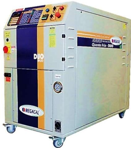
Água gelada e água quente em um só equipamento. O equipamento contém sistema de refrigeração e aquecimento em uma única estrutura, desta forma, pode atender dois pontos de consumo com temperaturas que podem ser ajustadas diferentes para cada saída e ser adequada a cada processo. Utiliza água como meio circulante e possui uma saída com temperatura controlada de 7°C a 25°C e outra de 10°C a 90°C.
